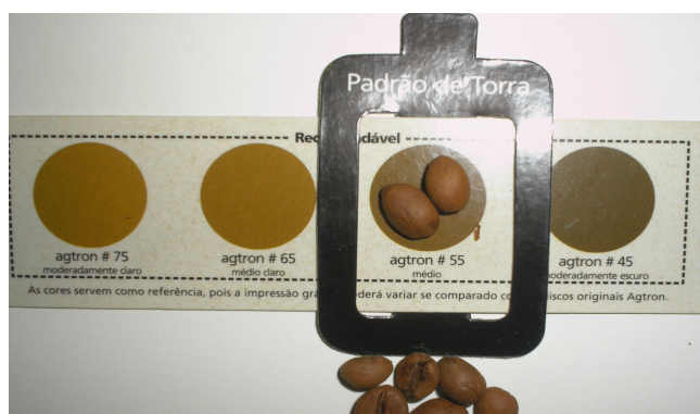
Figura 5. Comparação visual da torra obtida com o padrão dos discos coloridos de classificação do Sistema AGTRON/SCAA Roast Color Classification System .
