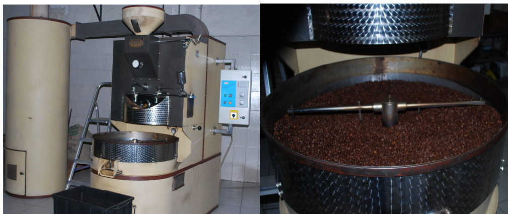
Figura 4. Equipamento utilizado para torrar as amostras de café.
