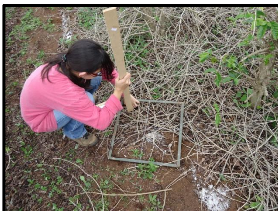
Figura 5 – Medida da altura do resíduo orgânico – matéria orgânica não decomposta, na superfície do solo
