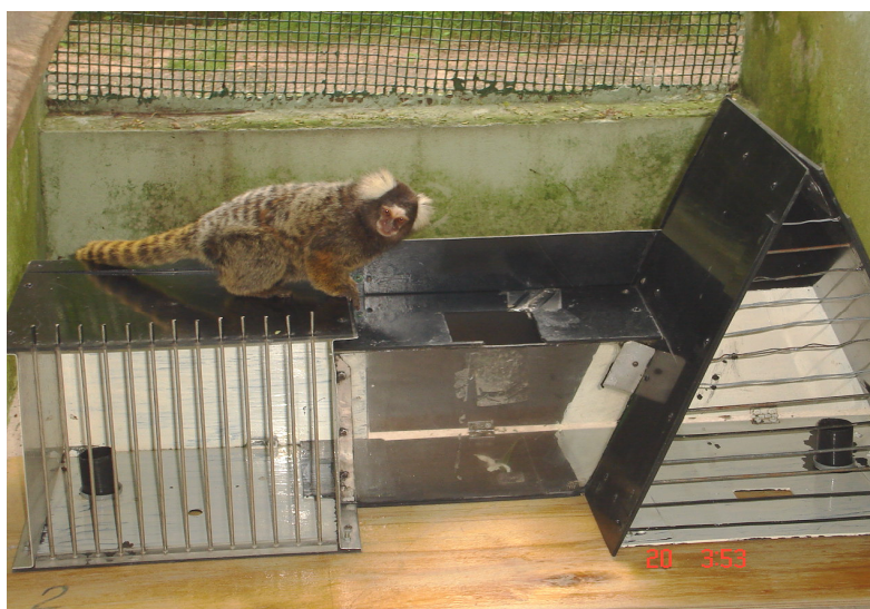
Figura 5: Aparato experimental utilizado para a tarefa de condicionamento de lugar. Foto: Kathiane dos Santos Santana.
