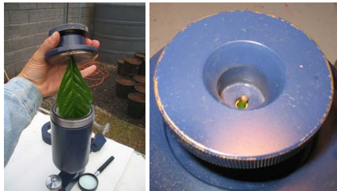
Figura 3 - Vista da folha do cafeeiro conilon na câmara de pressão da bomba tipo Scholander.
