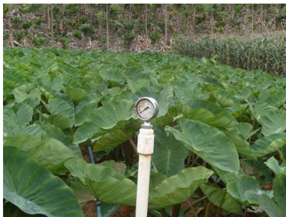
Figura IV.3 - Uso do manômetro para aferir a pressão de serviço dos aspersores.
