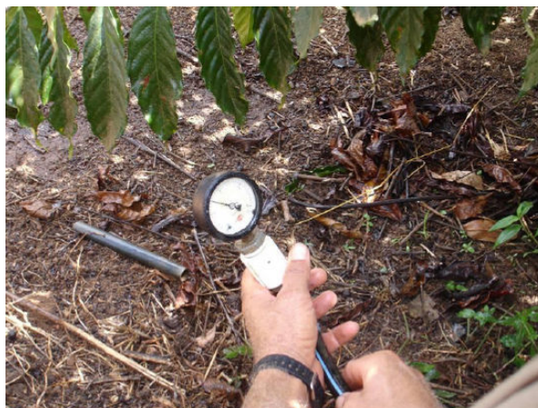
Figura IV.6 - Aferição de pressão no final da linha lateral com o uso de manômetro.
