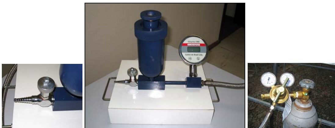
Figura 2 - Componentes da bomba tipo Scholander.
