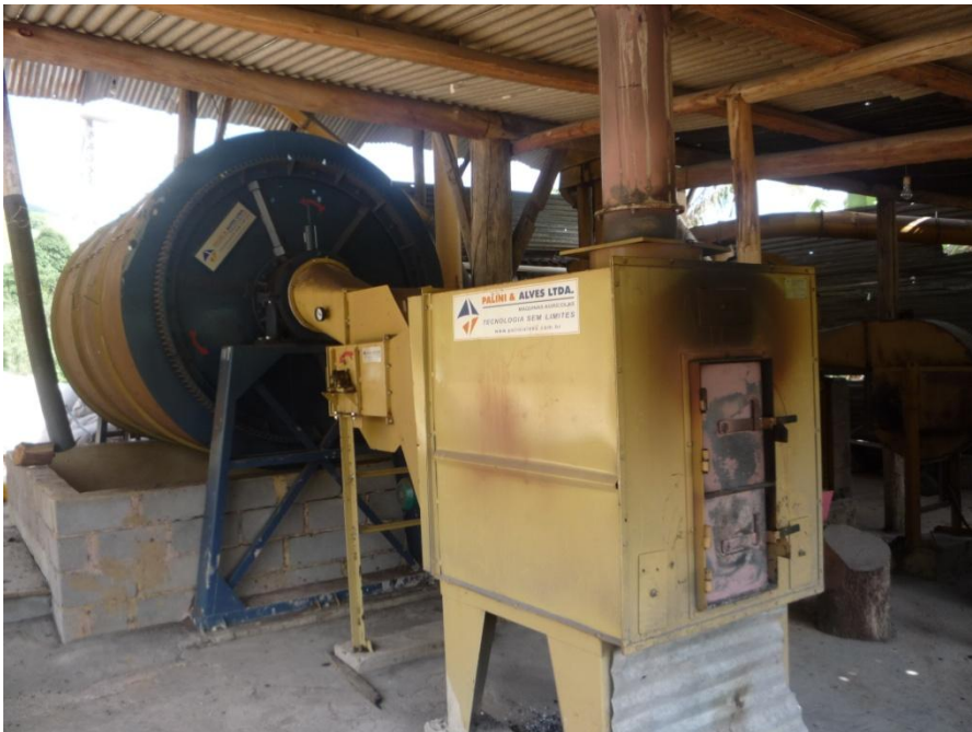
Figura 10C – Secador de fogo indireto, temperatura máxima de 60° C na massa do café. Mimoso do Sul, 2010.
