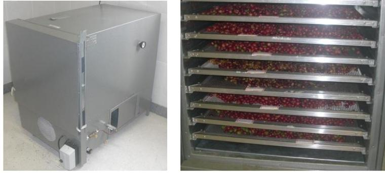
Figura 3 - Secador com bandejas, utilizado para secar o café.
