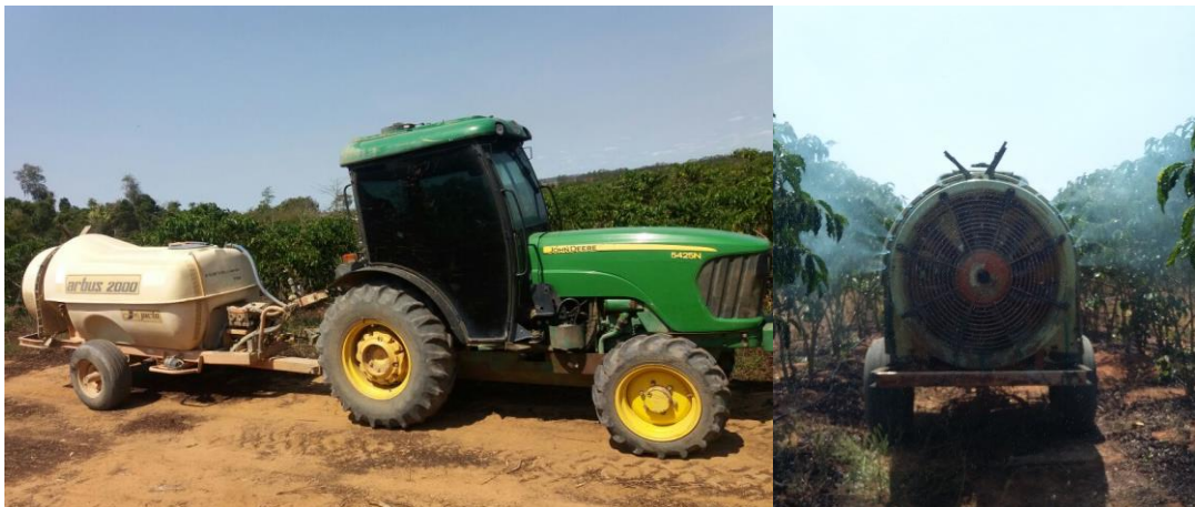
Figura 1. Pulverizador marca Jacto, modelo Arbus 2000 TF, acoplado a um trator JOHN DEERE 5425N, aplicando calda contendo traçador + água em lavoura de café conilon.
