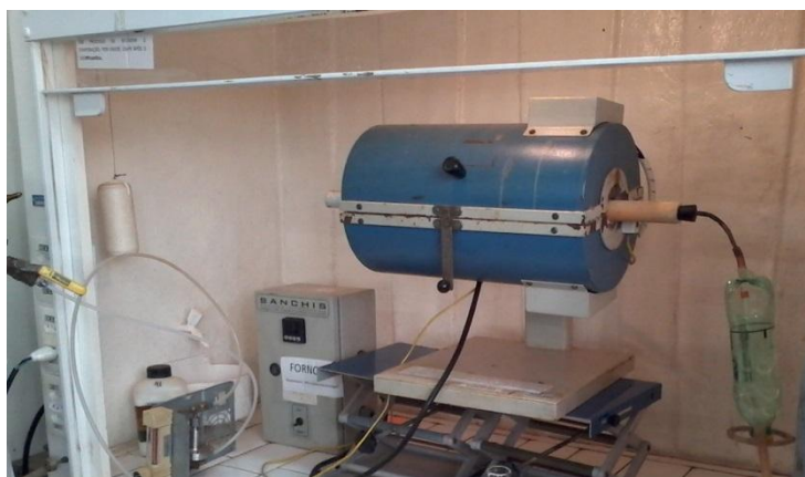
Figura 13 - Sistema de pirólise e coleta das frações.
