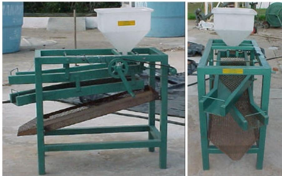
**Figura 1** - Vista lateral e frontal do protótipo da Abanadora Mecânica com Acionamento Manual para Café.
